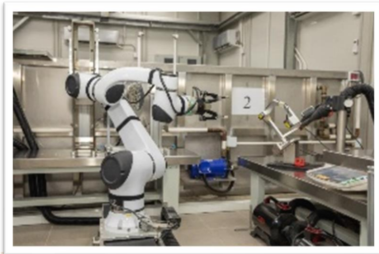
自動化混凝土磚測試系統 Automated system for concrete cube testing system
