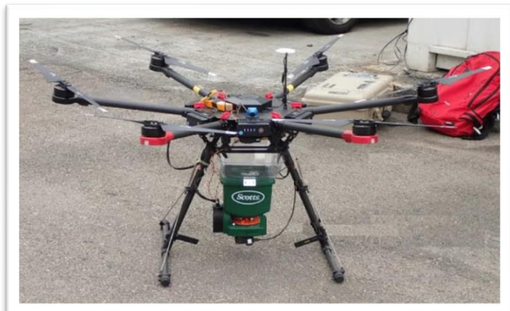
研究中使用的無人機及撒播器 UAV with seed spreader used in the study
